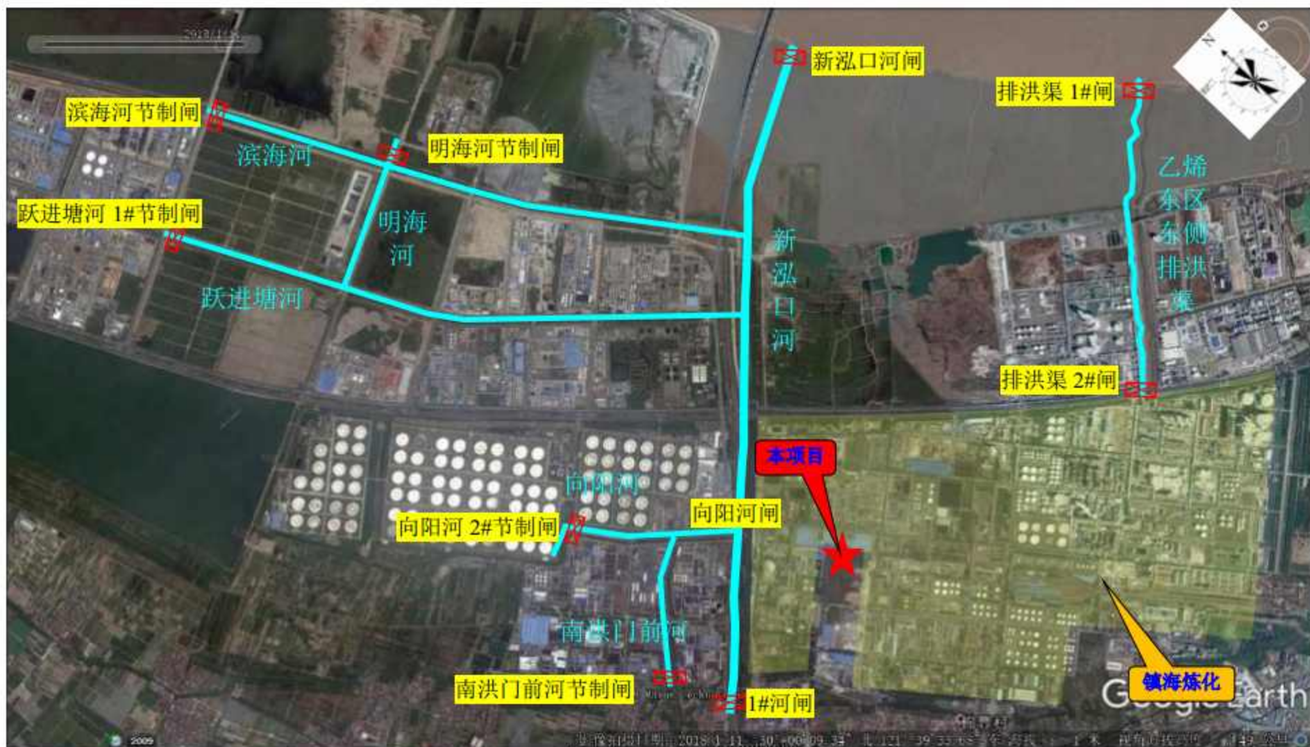
图 7.7-3 石化区防洪渠截断封堵设施示意图
