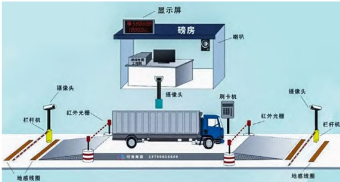
承运商网上按订单拆分成分订单，预约后司机和车辆可自动识别入厂，经过无人值守过磅，使用视频自动分析司机违规行为，装卸区 AGV 机器人自动装车，出厂自动过磅并生成电子出厂票，门岗移动端电子核验放行
